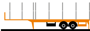
8x 2 as platte stuurbare trailers met gekeurde zijrongen voor buizentransport ⇄ van 10,90m tot 16,40m
